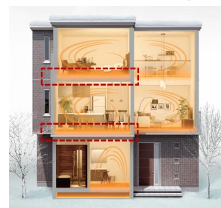
…放熱シートを敷設
